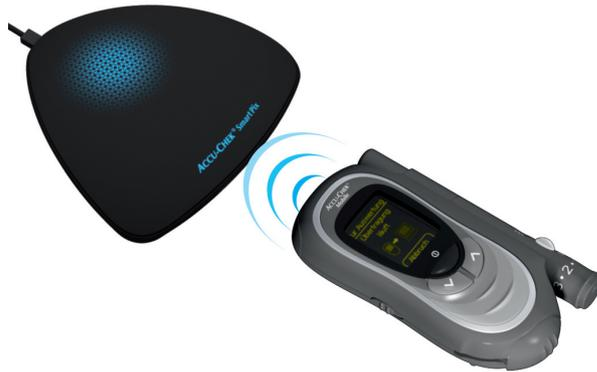
El medidor de glucemia Accu-Chek Mobile (modelo U8) dispone de una interfaz de infrarrojos incorporada para la transferencia de datos. Para leer datos de estos dispositivos, debe proceder de la manera siguiente:
