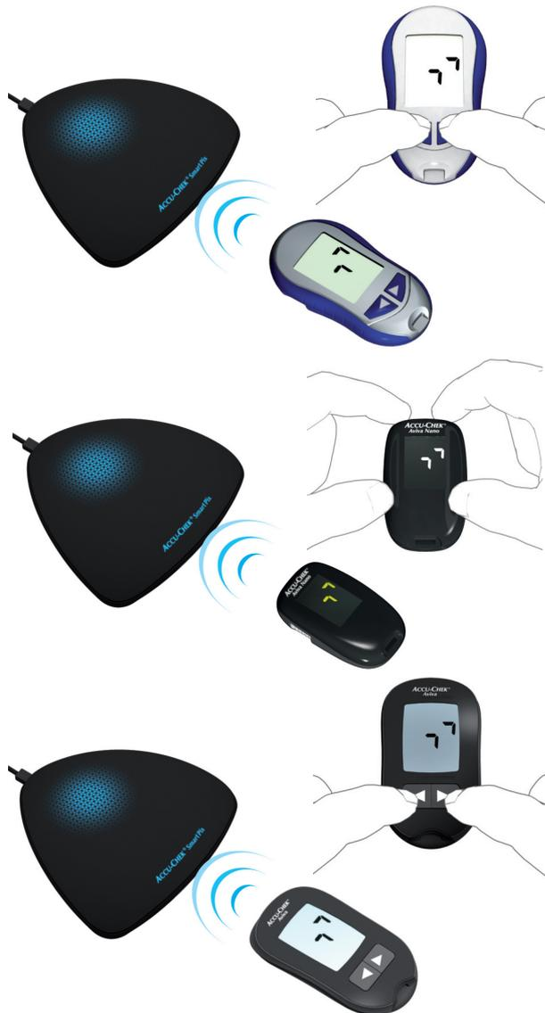
Los medidores de glucemia Accu-Chek Aviva y Accu-Chek Aviva Nano disponen de una interfaz de infrarrojos incorporada para la transferencia de datos. Para leer datos de estos dispositivos, debe proceder de la manera siguiente:
