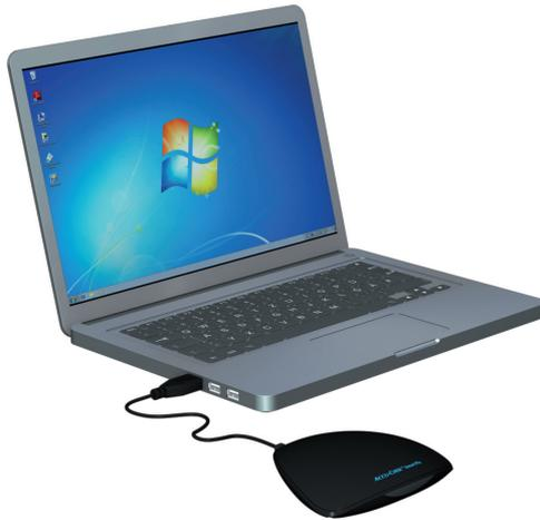
Para copiar el software del dispositivo Accu-Chek Smart Pix (modelo 2): enchufe el conector USB del dispositivo Accu-Chek Smart Pix a un puerto USB libre de su ordenador. Puede hacerlo con el ordenador apagado o encendido. El dispositivo Accu-Chek Smart Pix también recibe corriente a través de esta conexión y por lo tanto no necesita pilas ni unidad de alimentación.
