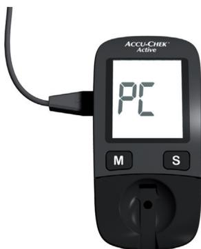
El medidor de glucemia Accu-Chek Active (modelo GU y GB) dispone de una interfaz USB incorporada para la transferencia de datos.
