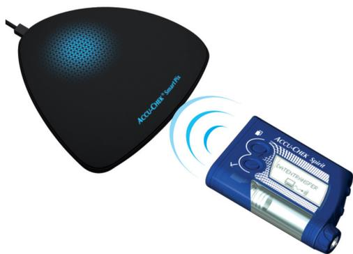
El sistema de infusión de insulina Accu-Chek Spirit dispone de una interfaz de infrarrojos incorporada para la transferencia de datos. Para leer datos de estos dispositivos, debe proceder de la manera siguiente:
