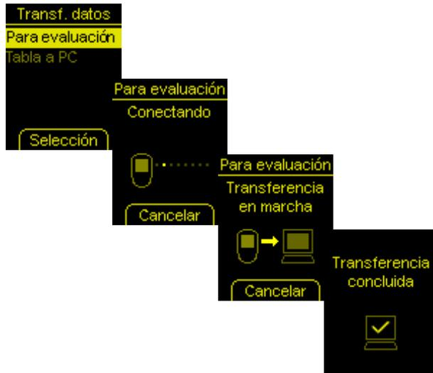
Se establece la conexión y se transfieren los datos. Una vez finalizada la transferencia de datos, se abre durante dos segundos la pantalla *Transferencia concluida*. A continuación se desconecta el medidor.
