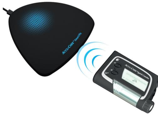
El sistema de infusión de insulina Accu-Chek Spirit Combo dispone de una interfaz de infrarrojos incorporada para la transferencia de datos. Para leer datos de estos dispositivos, debe proceder de la manera siguiente:
