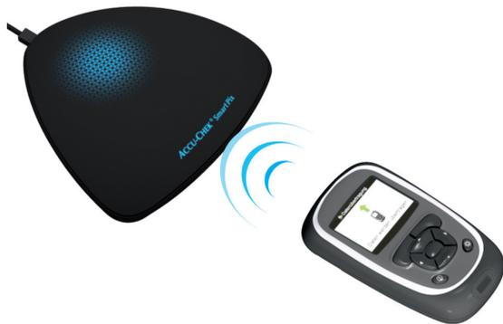
Los medidores de glucemia Accu-Chek Aviva Combo y Accu-Chek Aviva Expert disponen de una interfaz de infrarrojos incorporada para la transferencia de datos. Para leer datos de estos dispositivos, debe proceder de la manera siguiente:
