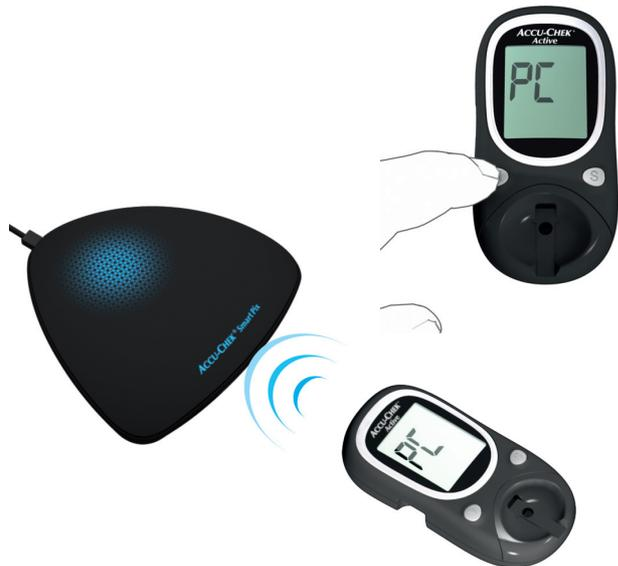
El medidor de glucemia Accu-Chek Active (modelo GG, GN y GC) dispone de una interfaz de infrarrojos incorporada para la transferencia de datos. Para leer datos de estos dispositivos, debe proceder de la manera siguiente:
